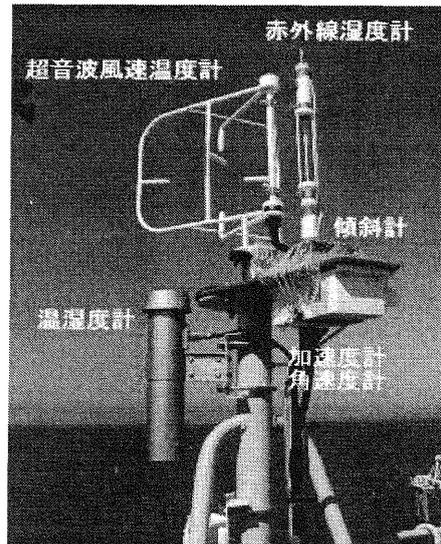
第1図 前部マスト頂部の乱流計測機器
