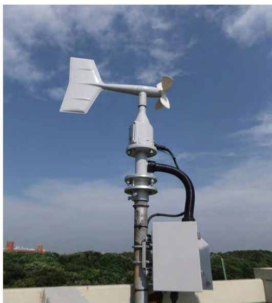
写真4 風向風速計 (外観)
